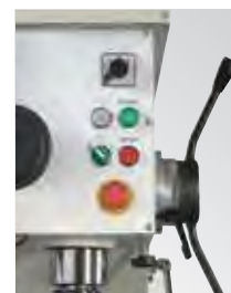
Avanzamento automatico canotto (IME-MPA40TM)
