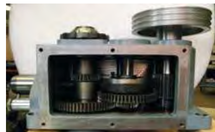
Scatola ingranaggi in bagno d'olio.
